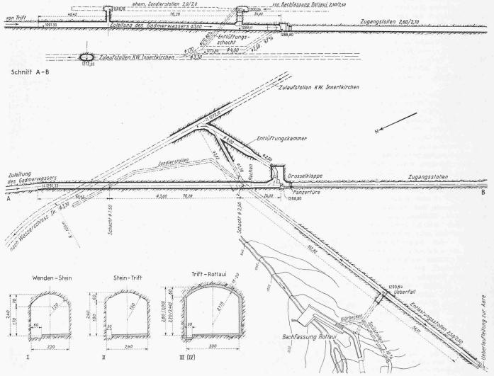
Bild 2. Anschluss des Gadmerstollens an den Stollen Handeck-Innertkirchen mit Fassung des Rotlaui-Baches. Masstab 1:1500; unten links Stollenprofile 1:150
