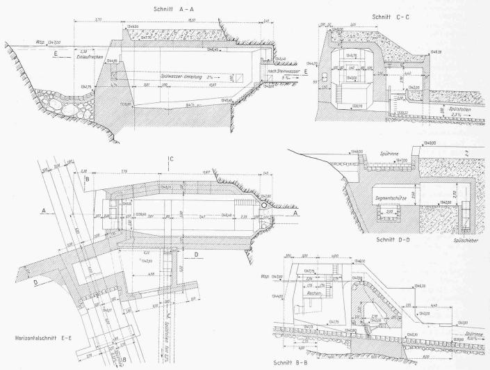
Bild 6. Bauliche Einzelheiten der Wendenwasserfassung, 1:300
