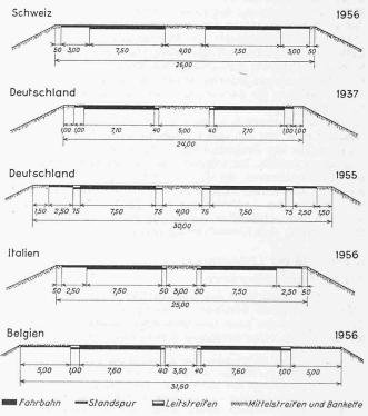
Bild 2. Autobahn-Querschnitte
