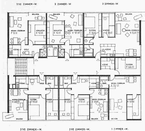
Grundriss der Turmbauten. 1:400
