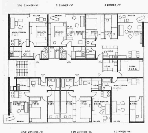
Grundriss der Turmbauten. 1:400
