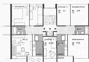
Wohnungsgrundriss der achtgeschossigen Bauten. 1:400
