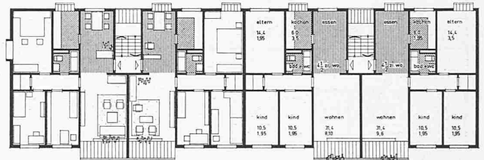
Grundriss des viergeschossigen Gebäudes. 1:400
