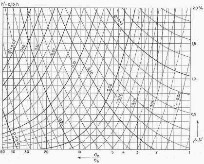
Bild 2. Rechteckquerschnitt unter Biegung mit Längskraft (grosse Exzentrizität) im elastischen Bereich; n=10 Text s. S. 93
