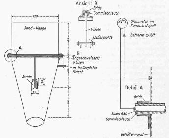
Bild 1. Anordnung der Sonde im Behälter der Sandwaage
