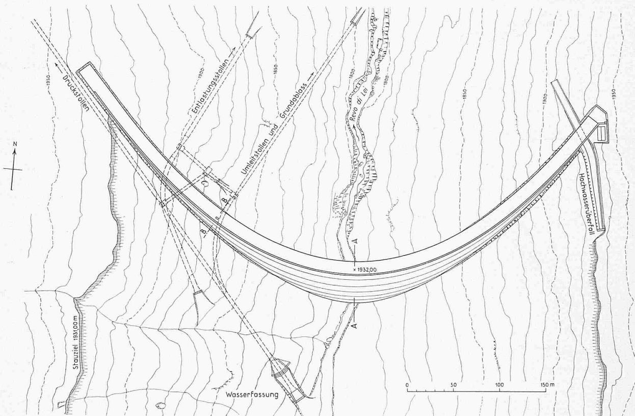
Bild 4. Die Staumauer Lei, Grundriss 1:4000
