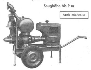
Leistungen 1—5000 I/sek. Kein Bodenventil. Keine Klappe im Saugstutzen. Keine Hilfs-Vakuum-Pumpe. Jederzeitiges automatisches Ansaugen auch nach Lufteinfritt im Saugrohr. Keine reibenden, sich abnützenden Dichtungsflächen, daher störungsfrei auch bei Schlamm-, Sand- und Kies-
