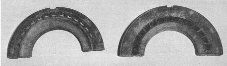
Bild 26. Eines der ersten Leiträder nach 10 000 Betriebsstunden
