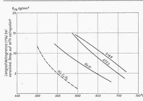
Bild 15 (links). Zeitstandfestigkeit 200 einiger warmfester Stähle in Abhängigkeit der Temperatur. Die Ordina-kcal/kg ten geben die Zugspannungen an, die eine Dehnung von 1% nach 105 Stunden bewirken. Die Messungen wurden während kürzerer Zeit vorgenommen und auf die 105 Stunden linear extrapoliert. Vis C2 D2 ist ein ferritischer, die andern sind austhenitische Stähle.
