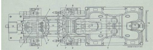
Bild 12. Anordnung der Ventile und der Regulierung einer dreigehäusigen Dampfturbine für Betrieb mit Zwischenüberhitzung
