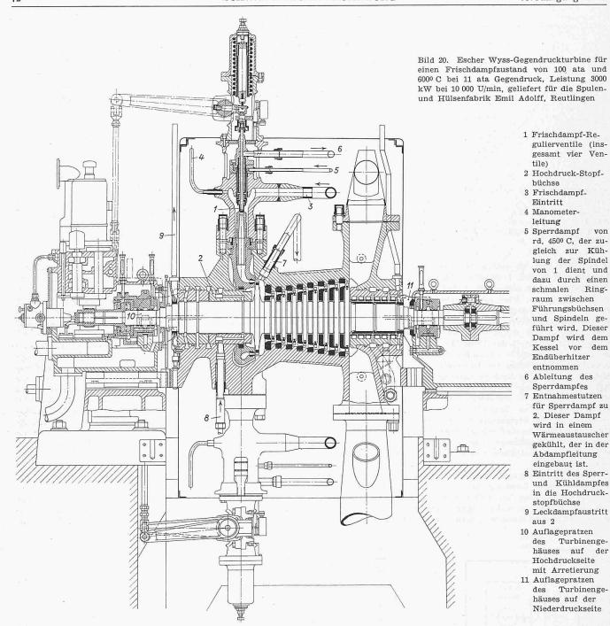
damit der Dampfdurchsatz durch die Gegendruckturbine auf 25,7 t/h. Dementsprechend vergrössert sich die Leistung der Gegendruckturbine nicht im Verhältnis der verfügbaren adiabatischen Gefälle, also nicht um 18,4 % (Bild 16), sondern nur um rd. 8 %. Die geringe Leistungssteigerung um nur 290 kW auf 3660 kW rechtfertigt die erheblichen Mehr-
