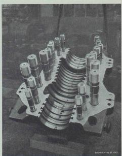
Bild 22. Turbinengehäuse-Unterteil
