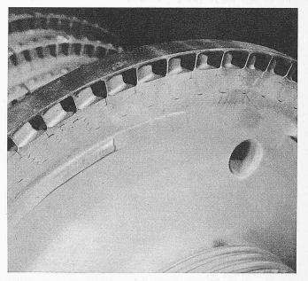
Bild 27. Erstes Laufrad aus austhenitischem Stahl, die Laufschaufeln mit Tannenbaumfüssen (Aufnahme nach 10 000 Betriebsstunden)
