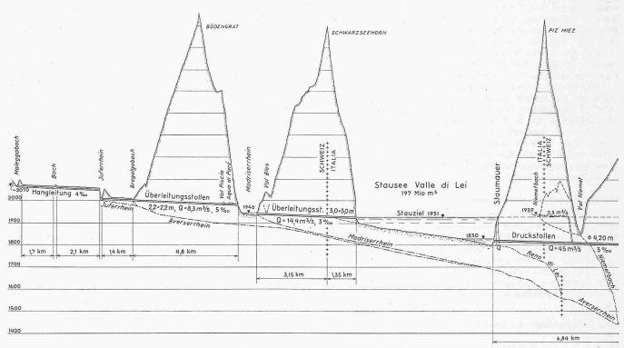
Bild 3. Uebersichtslängenprofil, Längen 1:150000, Höhen 1:15000
