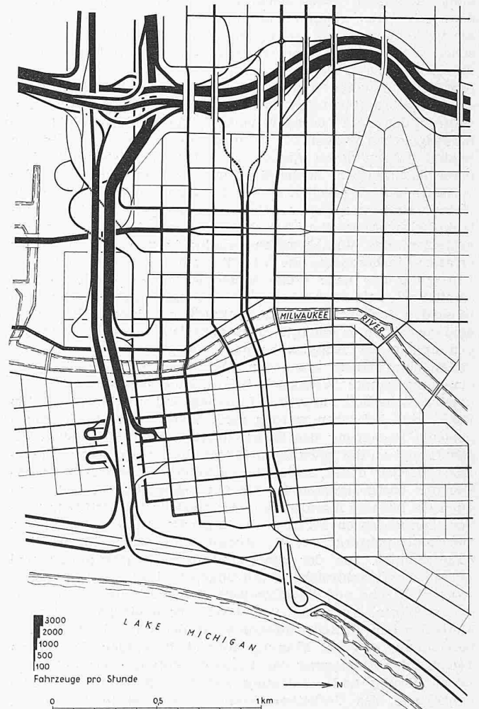
Bild 5. Das gleiche Gebiet, Spitzenbelastung 1980, falls die Expressstrassen gebaut werden. — Untersuchungen des Büros Ammann & Whitney, New York
