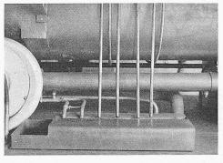
Bild 14. Gefäss aus verzinntem Kupferblech zum Auffangen von Kondenswasser und Abdampf der Mangen mit sichtbarem Abfluss
