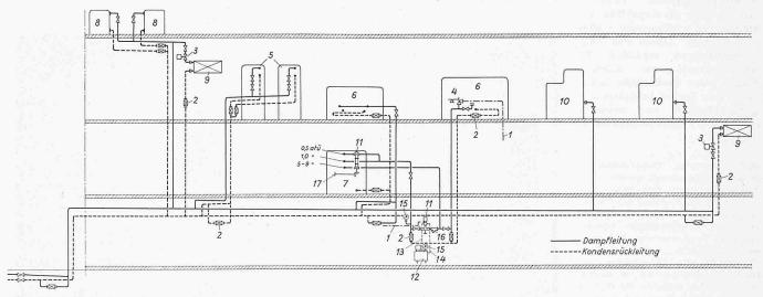
Bild 8a. Prinzipschema der Dampfleitungen
