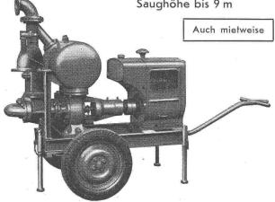
Leistungen 1-5000 I/sek. Kein Bodenventil, Keine Klappe im Saugstutzen. Keine Hilfs-Vakuum-Pumpe. Jederzeitiges automatisches Ansaugen auch nach Lufteintritt im Saugrohr. Keine reibenden, sich abnützenden Dichtungsflächen, daher störungsfrei auch bei Schlamm-, Sand- und Kiesförderung.
