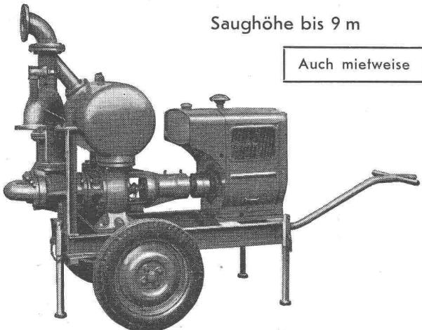
Leistungen 1—5000 l/sec. Kein Bodenventil. Keine Klappe im Saugstutzen. Keine Hilfs-Vakuum-Pumpe. Jederzeitiges automatisches Ansaugen auch nach Lufteintritt im Saugrohr. Keine reibenden, sich abnutzenden Dichtungsflächen, daher störungsfrei auch bei Schlamms-, Sand- und Kiesförderung.
