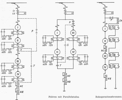
Bild 6. Prinzipschema der Hauptstromkreise
