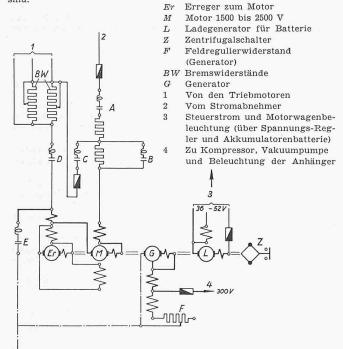
Bild 7. Schaltschema der Umformergruppe von 2500 V
