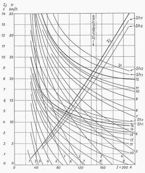
Bild 1. Anfahrcharakteristik bei vier Motoren und einer Spannung von 1000 V pro Motor
