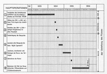
Bild 15. Reihenfolge und effektive Dauer der die Bauzeit bestimmenden acht Hauptarbeiten
