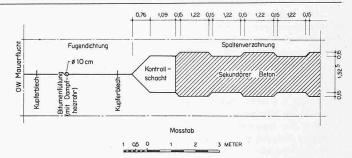
Bild 8. Fugenausbildung zwischen den Staumauerblöcken, Horizontalschnitt 1:150
