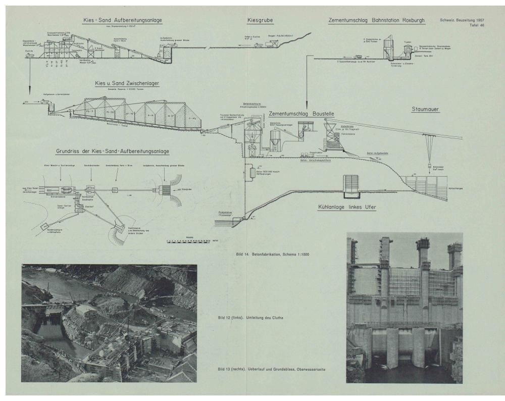
Der Einbau des Grundablasses, des Ueberlaufes und der Wasserfassungen in den Staukörper ist durch die Topographie des umliegenden Geländes bedingt. Ihrer Ausbildung entsprechend ergeben sich, vom linken Widerlager beginnend: 6 Widerlagerblöcke (links); 8 Wasserfassungsblöcke mit vorgebauter Einlauftrompete, enthaltend Rechen, Dammbalkenführung und Abschlusschütze; 2 Zwischenblöcke mit Turmaufbau für Personenlift; 4 Blöcke mit Ueberlauf und Grundablass; 3 Widerlagerblöcke (rechts).
