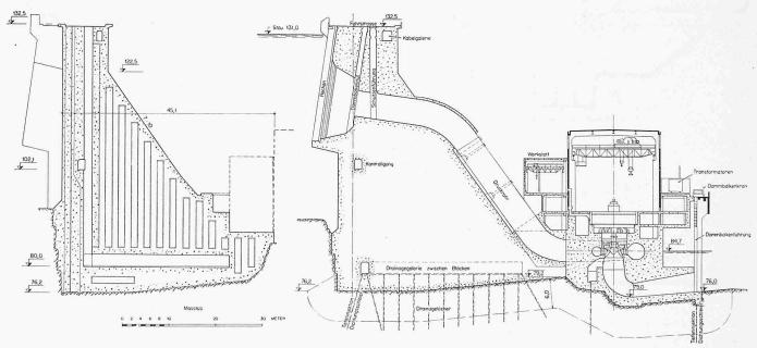
Bild 9. Querschnitt A-A (vgl. Bild 4), Maschinenhaus und Wasserfassungsblock
