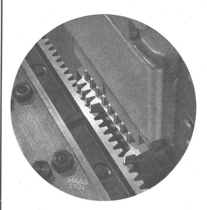
Wir empfehlen uns für das rationelle Stossen **genauer Zahnstangen** mit geraden oder schrägen Zähnen bis 250 mm Zahnbreite.
