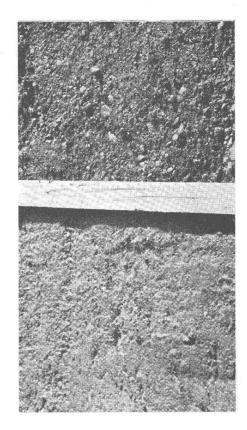
Der Baustellenversuch zeigt deutlich die wesentlich kompaktere Masse und die leichtere Verdichtbarkeit des Betons durch Zusatz von 1% Plastopor
