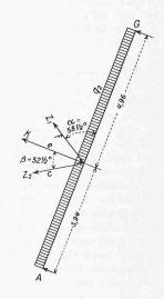
Bild 7. Schneedruck und Kräfte an der Diagonalen b
