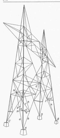
Bild 2. Mast 317 mit Bezeichnung der Stützpunkte und Stäbe
