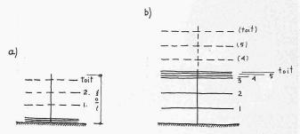
Fig. 5. Première et deuxième étapes de construction d'un bâtiment de 5 étages sur rez de chaussée
