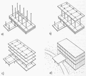
Fig. 1. Esquisses montrant l'ordre des opérations: a) les poteaux encastrés dans la dalle du rez-de-chaussé et les dalles des niveaux supérieurs sont bétonnés sur celle-ci; b) la dalle de la terrasse est hissée; c) toutes les dalles sont à leurs places définitives; d) les sommets des poteaux sont décapés et les parois extérieures posées
