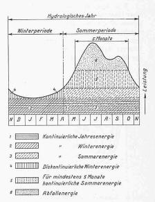
Bild 5. Typischer Jahresverlauf der Leistung einer Wasserkraft-Werkgruppe
