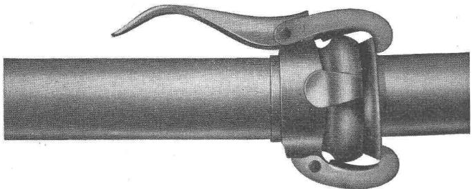
aus Bandstahl, überhaupt geschweisst, absolut dicht, stark abwinkelbar, feuerverzinkt. Durchmesser: 50, 62, 70, 89, 108, 133, 159 mm. Sämtliche Armaturen.
