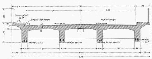
Bild 4. Querschnitt im Scheitel, Masstab 1:80
