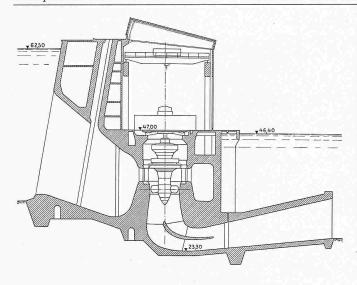
Bild 13. Querschnitt durch das Kraftwerk, 1:700
