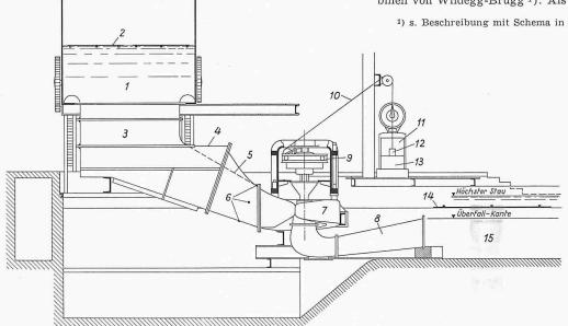
Bild 19. Prüfstand im Werk der Firma Bell in Kriens zur Vornahme der Abnahmeversuche an der Modellturbine
