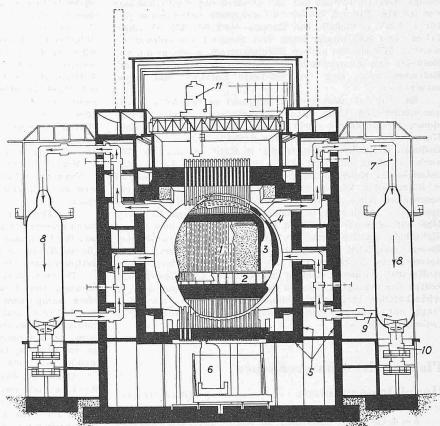
Bild 1. Schematischer Querschnitt durch den Reaktor der G. E. C.-Simon-Carves Atomic Energy Group; Masstab etwa 1:600
