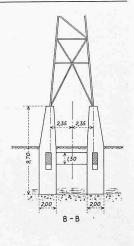
Bild 9. Hohe Eisenbetonsockel eines Mastes der Campolungo-Leitung, rahmenartig miteinander verbunden, in einem Hochmoor gelegen; 1:400
