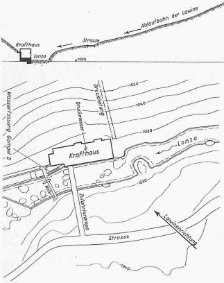
Bild 4. Kraftwerk Gampel III. Oben Querprofil des Tales (1:2500); unten Lageplan des Maschinenhauses und Lawinenrichtung (1:1500)
