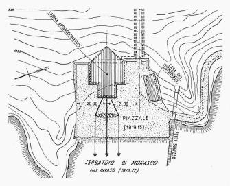
Bild 6. Kraftwerk Morasco im Val Formazza. Beispiel einer Schaltanlage an einem Lawinenhang. Die Schneemassen werden durch das keilförmige, stark armierte Betondach aufgespalten und auf beide Sei-
