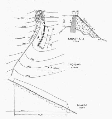
Bild 13. Ablenkmauer an der Lukmanier-Leitung bei S. Gagl in Trokkenmauerwerk mit Hinterfüllung
