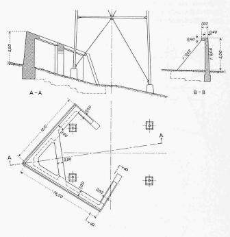
Bild 14. Schutzkeil eines Mastes der Lukmanier-Leitung in Eisenbeton oberhalb Acla; 1:400
