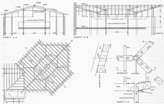
Dachstuhl Ausstellungshalle. Oben Schnitte A-A und B-B, M. 1:150, unten links Sparrenlage M. 1:200, unten rechts, Details, M. 1:25
