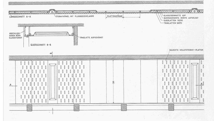
Korridordecke, Masstab 1:40, oben Längs- und Querschnitt, unten Untersicht, rechts Detail Masstab 1:8
