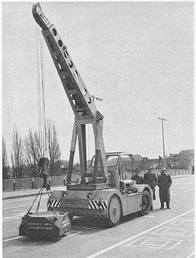
Bild 53. Belastung mit der Vorderachse eines mit einer 6-t-Platte belasteten Kranwagens
