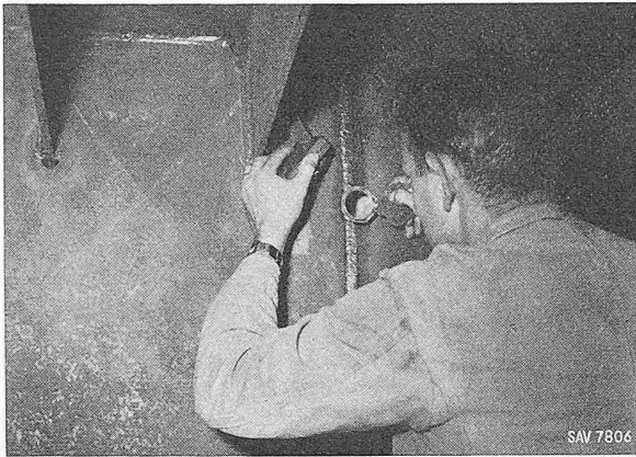
Bild 42. Schweissnahtkontrolle von Auge mit der Lupe
