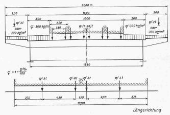
Bild 35. Verkehrslasten für die Fahrbahn
