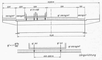
Bild 36. Verkehrslasten für die Hauptträger
