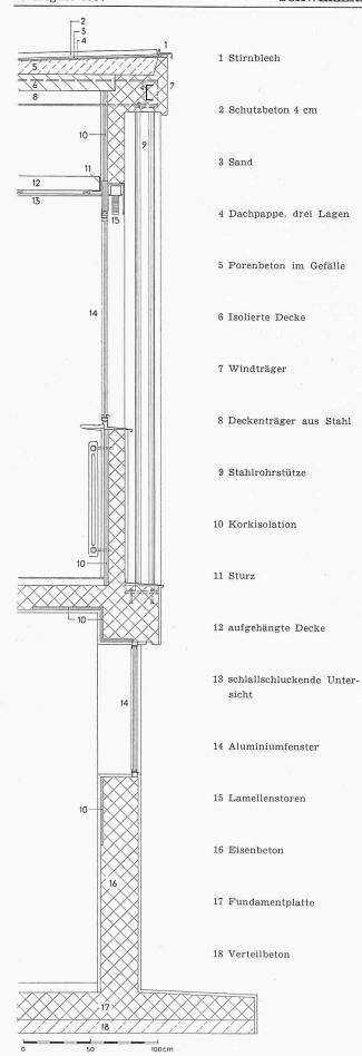
Fassadenschnitt, Masstab 1:30 der Tetra-Werkstätte in Dietlikon
