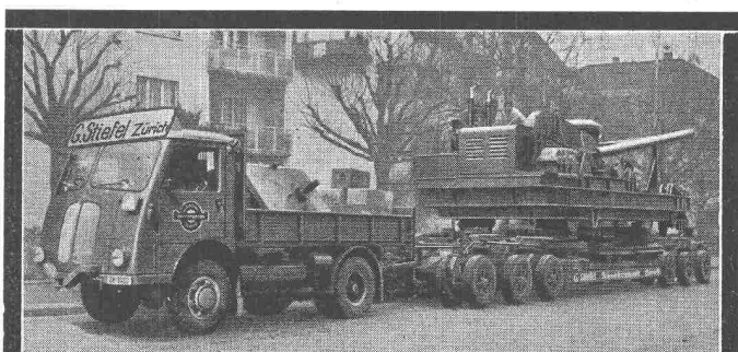
Transport eines 54 Tonnen schweren Rammenfusses auf dem 24fach beladenen Schwertransportanhänger mit dem starken Allrad-Zugwagen mit Seilwinde.
