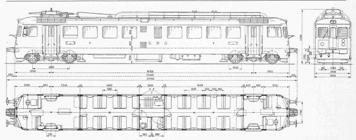
Bild 10. Personentriebwagen der Bern-Neuenburgbahn von 2000 PS. Pro totyp für die geplanten Hochleistungs-Personentriebwagen, im besondern für Pendelzugdienst
