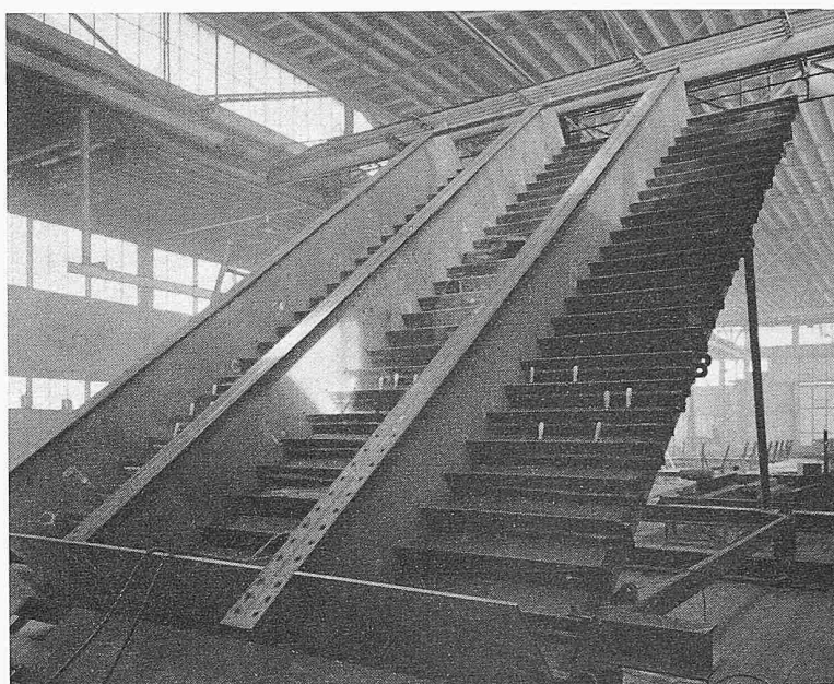
Bild 26. Orthotrope Platte in der Werkstätte, gesehen von unten (Die hellen Stücke sind die Holzgriffe der Kupferschienen für die Schweissung). Grösse des Stückes 5 \times 8 m. Nach dem Umdrehen werden zwei solche Stücke vor dem Transport auf die Baustelle zu einer Tafel von 5 \times 16 m zusammengeschweisst
