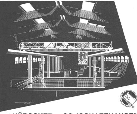
Schweiz. Reederei Basel Laufkran im Umschlaghof Tragkraft 3000 kg Spannweite 15 m Schützensteuerung Katzfahren: 40 m/min
