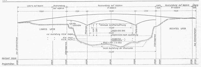
Bild 8. Längenprofil 1:3000/1:600 (fünffache Ueberhöhung) mit dem im Hinblick auf die Rheinschiffahrt einzuhaltenden freien Durchfahrtsprofil in der Mittelöffnung. Die eingetragenen Wasserspiegel beziehen sich auf den Zustand nach Fertigstellung der zurzeit noch im Gang befindlichen Austiefung der Rheinsohle
