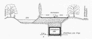
Bild 3. Schematischer Querschnitt 1:800 des für den Brauchwasserabfluss eingeengten Sihlbettes, welcher die gewonnene Verkehrsfläche für die Autobahn zeigt. Der Hinweis auf den Anschluss von Sihltalbahn und SBB an die Station Enge bezieht sich auf das unterirdische Stadtbahnnetz, welches der Verfasser entworfen hat, auf das aber in diesem Zusammenhang nicht eingetreten wird.
