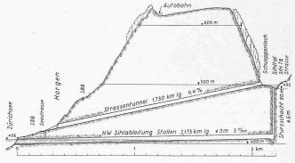
Bild 2. Längenprofil (fünffach überhöht) der Hochwasserableitung der Sihl in den Zürichsee. Oberhalb des Sihlstollens kann ein Strassentunnel angelegt werden, welcher als Basisverbindung von den Seestrassen (Fähre Horgen - Meilen) zur Sihltalstrasse und Autobahn Zürich - Süd und zur Innerschweiz dienen könnte.
