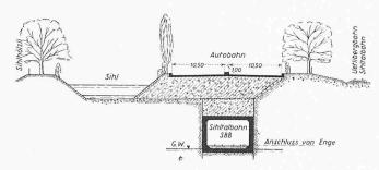
Bild 3. Schematischer Querschnitt 1:800 des für den Brauchwasserabfluss eingeengten Sihlbettes, welcher die gewonnene Verkehrsfläche für die Autobahn zeigt. Der Hinweis auf den Anschluss von Sihltalbahn und SBB an die Station Enge bezieht sich auf das unterirdische Stadtbahnnetz, welches der Verfasser entworfen hat, auf das aber in diesem Zusammenhang nicht eingetreten wird.
