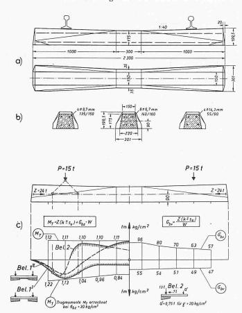
Bild 1. Spannbetonschwelle B55der Deutschen Bundesbahn, a Form, b Bauarten,  ${\bf c}$ statische Werte
