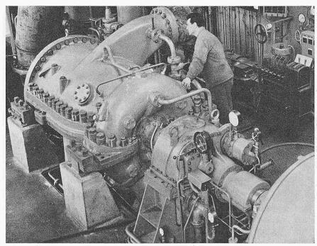
Bild 5. TUCO-Anlage für 2000 kW Nutzleistung auf dem Prüfstand
