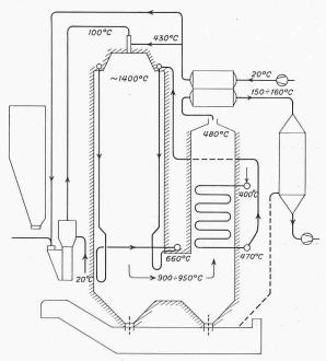
Bild 11. Schema des kohlenstaubgefeuerten Lufterhitzers mit Arbeitstemperaturen
