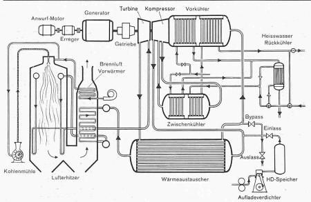
Bild 7. Prinzipschema der Heissluftturbinenanlage Ravensburg
