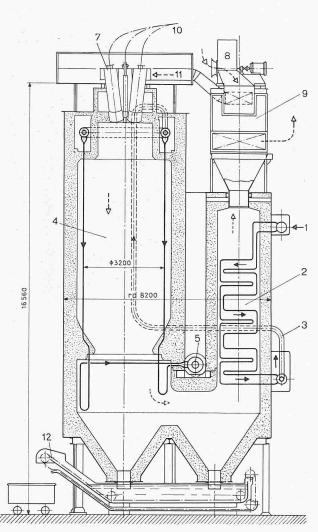
Bild 12. Schnitt durch den Lufterhitzer der Anlage Ravensburg von 2000 kW mit Kohlenstaubfeuerung, Masstab $1\colon\!120$
