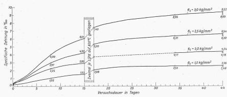
Bild 1. Dehnungversuche aus dem Jahre 1937 an Lufterhitzerrohren aus Chrom-Nickel-Stahl 25/20 bei 7200 C
