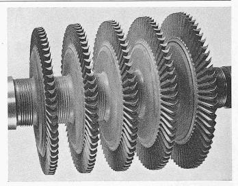
$\operatorname{Bild}$  2. Rotor der Hochdruckturbine der ersten Versuchsanlage von 2000 kW
