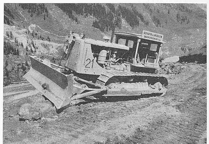
Bild 2. Bulldozer Caterpillar D 8, Gewicht 22 t, Motorenleistung 190 PS
