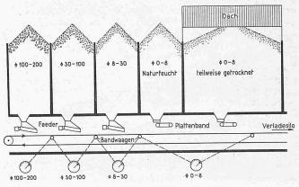
Bild 6. Dosier-Einrichtung für das Material der Zone 3
