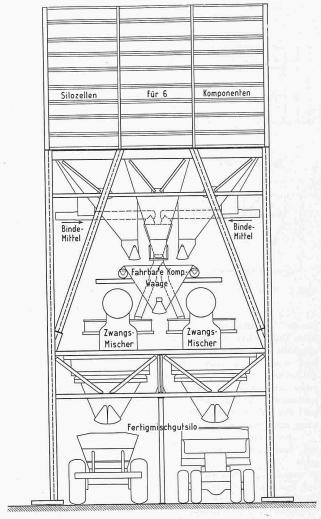
Bild 5. Schema eines Mischturmes
