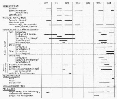
Bild 9. Zusammenstellung der für den Staudamm Göschenenalp durchgeführten erdbaumechanischen Untersuchungen der Jahre 1950/56, wobei die Voruntersuchungen auf die Jahre 1950/59 entfallen
