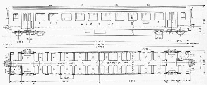
Fig. 20. Nouvelle voiture des CFF légère de 3<sup>me</sup> classe (actuelle 2<sup>me</sup>), à couloir central, avec deux grandes plateformes situées aux extrémités du véhicule. Sièges légèrement rembourrés; 80 places. Chauffage à air pulsé. En service depuis 1956.
