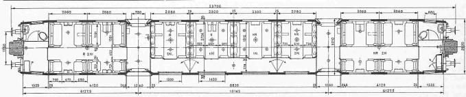
Fig. 19. Voiture des CFF légère mixte 1<sup>re/2me</sup> classes, à couloir latéral et central, avec plateformes reportées vers le milieu du véhicule; 12+36 = 48 places. Partie à couloir latéral avec sièges à oreillers mobiles. En service depuis 1951.
