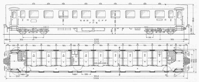
Fig. 22. Voiture des CFF légère de 3<sup>me</sup> classe (actuelle 2<sup>me</sup>), à couloir latéral. 72 places; neuf compartiments; sièges rembourrés. Chauffage à air pulsé. En service depuis 1956.
