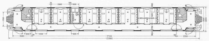
Fig. 21. Voiture des CFF légère mixte 1<sup>re/2me</sup> classes, à couloir latéral; 12+30 = 42 places. Sept compartiments en tous points identiques. Sièges à oreillers mobiles. Chauffage à air pulsé. Ces véhicules ont été construits en prévision de la fusion des deux classes supérieures. 1954.
