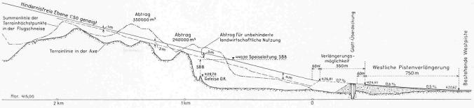
Bild 3. Längenprofil der Ausflugschneise von der Westpiste; Längenmasstab 1:20000; Höhenmasstab 1:1600
