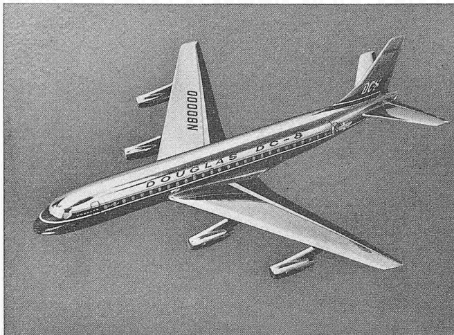
Bild 1. Das für 1959 erwartete Verkehrsflugzeug DC-8 mit vier Pratt & Whitney JT4-Düsenaggregaten. Fassungsvermögen 140 Touristen bzw. 110 Passagiere bei gemischter Bestuhlung
