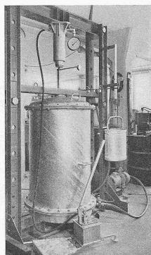
Bild 5. 10-Tonnen-Presse mit kleinem triaxialem Scherapparat zur Untersuchung von Kern- und Filtermaterialien für Probengrössen von 16 cm Höhe und 50 cm² Querschnittfläche
