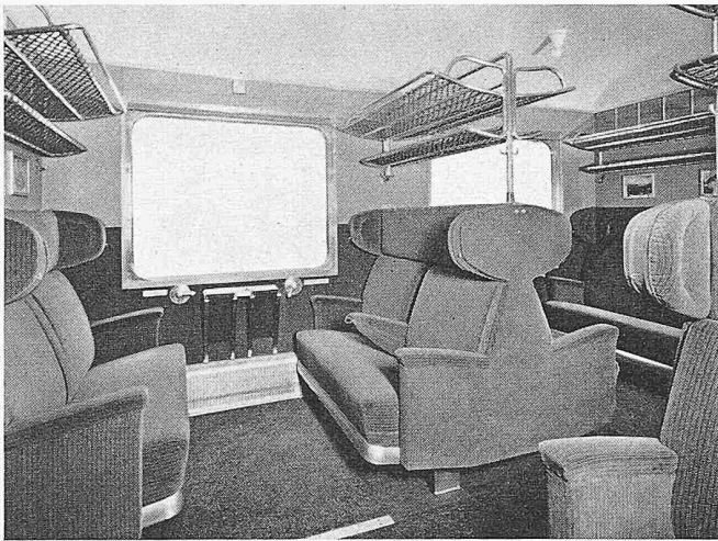
Fig. 4. Compartiment de 2 me classe, à couloir central, d'une voiture légère des CFF. Sièges de forme agréable; exécution soignée.
