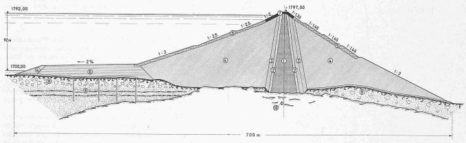
Bild 3. Staudamm-Querschnitt 1:4000
