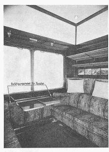
Fig. 1. Compartiment de 1<sup>re</sup> classe, avec sièges à oreillers mobiles, d'une voiture lourde des CFF, destinée au trafic international. Dimensionnement particulièrement large, note luxueuse.
