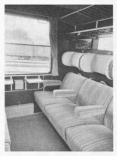
Fig. 10. Compartiment de 1<sup>†e</sup> classe des voitures de 26,4 m de longueur de la DB. Les 6 sièges ont leurs dossiers légèrement inclinables; leurs parcloses peuvent être rapprochées pour former 3 places couchées.
