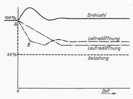
Bild 13. Zeitlicher Verlauf der Drehzahl sowie der prozentualen Oeffnungen der Leit- und Laufradschaufeln bei plötzlicher Teilentlastung von 100% auf 50% mit Stopsteuerung. Drehzahl und Netzfrequenz stabilisieren sich bedeutend rascher.
