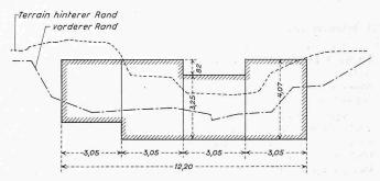
Bild 2. Querprofil des Baches 1:200 mit Eintragung der Sperre
