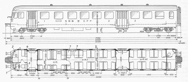
Fig. 2. Vue en élévation, frontalement et en plan, des rames ABFe<sup>4</sup>/<sub>8</sub> nos. 881/981 et 882/982 à courant continu, composées d'une
