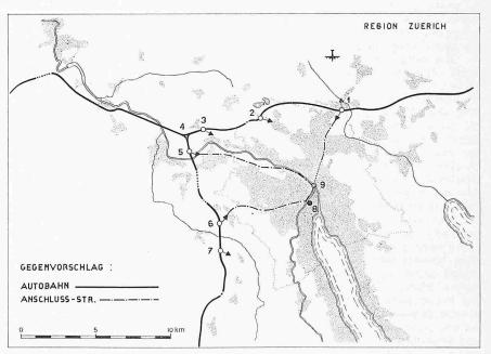
Bild 4. Hauptstrassenplanung Region Zürich, Gegenvorschlag, 1 Hauptanschluss Nord, 2 Anschluss Richtung West für Zürich 11, 3 Anschluss für Engstringen und Höngg, 4 Autobahndreicck, 5 Hauptanschluss West, 6 Hauptanschluss Südwest, 7 Anschluss Siedlungsbereich Wettswil
