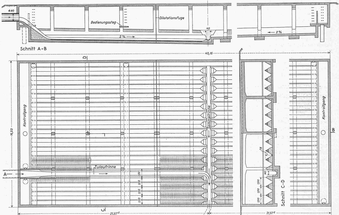
Bild 2. Rückhaltebecken «Tschanzmatte» in Muri bei Bern, Masstab 1:200
