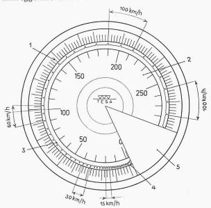
Zifferblatt des «Verigraph». 1 Geschwindigkeitskala (Teilstrichabstand 10 km/h), 2 Wegskala (Wegstrecke in m), 3 Zeitmarkenscheibe, dreht sich proportional der Fahrzeugseschwindigkeit, 4 Zeitmarken-Schreiber, 5 Schild, hinter dem sich die Auslöschvorrichtung befindet. Die Zeitmarken beziehen sich auf eine Fahrt mit anfänglich 100 km/h, bei der 190 m vor dem Hindernis die Bremsen einsetzten und das Fahrzeug unmittelbar vor dem Hindernis zum Stillstand brachten
