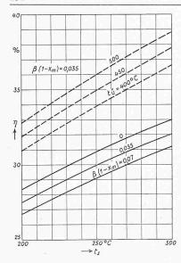
Bild 3. Thermische Wirkungsgrade von Dampfturbinenprozessen in Abhängigkeit der Verdampfungstemperatur  $t_s$  bezogen auf die im Wärmeaustauscher und einem allfälligen Ueberhitzer zugeführte Wärme und auf die Klemmenleistung von 50 MW. Die ausgezogenen Linien beziehen sich auf Sattdampfprozesse verschiedenen Verlustfaktoren, die gestrichelten Linien auf Prozesse mit zusätzlicher Ueberhitzung auf verschiedene Endtemperaturen  $t_{ii}$  bei einem Verlustfaktor  $\beta$  (1 —  $\chi_m$ ) = 0.035
