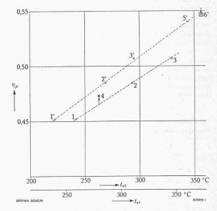
Bild 9. Prozesswirkungsgrade der Dampfkreisläufe Nr. 1 bis 6 der Tabelle 1 nach Bild 7 in Abhängigkeit der Austrittstemperatur  $tu_2$  des Natriums aus dem sekundären Wärmeaustauscher. Die untere Linie (Punkte 1, 2, 3, 4) bezieht sich auf eine Anordnung mit einer wirksamen Temperaturdifferenz von 60°C, die obere Linie (Punkte 1', 2', 3', 5', 6') auf eine solche mit  $30^{\circ}\,\mathrm{C}.\ tu_{1}$  ist die Austrittstemperatur des Natriums aus dem primären Wärmeaustauscher
