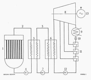
Bild 7. Prinzipschema einer Atomkraftanlage mit primärem und sekundärem Natriumkreislauf
