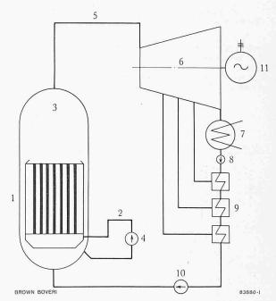
Bild 5. Prinzipschema eines Verdampfungsreaktors mit Dampfkraftanlage
