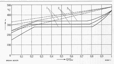
Bild 8. Temperaturverlauf im sekundären Wärmeaustauscher in Abhängigkeit der übertragenen Wärmemenge. 1, 2, 3 Prozesse nach Tabelle 1, Nrn. 1, 2, 3.
