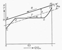
Bild 6. Temperaturverlauf im Wärmeaustauscher in Abhängigkeit der übertragenen Wärmemenge
