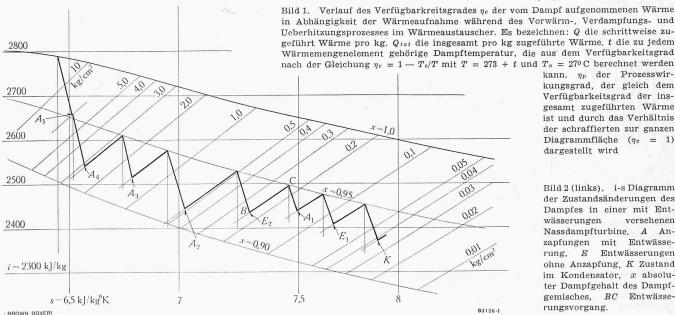
kann. np der Prozesswirkungsgrad, der gleich dem Verfügbarkeitsgrad der insgesamt zugeführten Wärme ist und durch das Verhältnis der schraffierten zur ganzen Diagrammfläche ( $\eta_c = 1$ ) dargestellt wird
