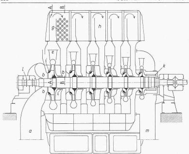
Bild 4. Schematischer Längsschnitt durch einen sechsstufigen Oerlikon-Bergwerkskompressor
